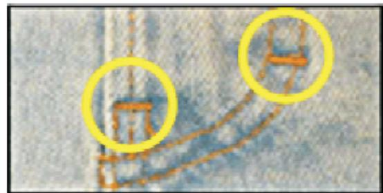
**MINIMIZANDO LAS FALLAS DE LA COSTURA - TELA:** 1) Reforzar los puntos más expuestos con remates. Asegurarse que los remates sean del largo y el ancho apropiado para la aplicación; 2) Cerciorarse que los patrones de medidas hayan sido diseñados en forma exacta; 3) Asegurarse que haya sido usada la construcción ideal de costura; 4) Contactar su proveedor de telas. .
