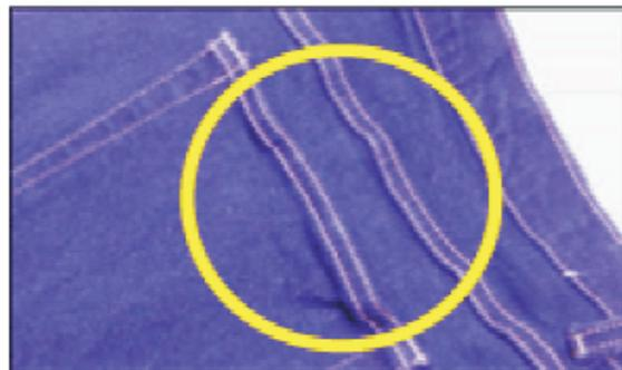
**SOLUCIONES:** 1) Si las maquinas son equipadas con impelente/impulsor de diferencial, graduar estos apropiadamente para el tipo de tela; 2) Usar presión mínima del pie prensatelas durante la costura; y 3) Observar las técnicas apropiadas de manejo del operador. Si la tela es estirada demasiado por el operador durante el proceso de la costura, esto causará el problema. (Ver *Cosiendo Tejidos Elásticos.*)
