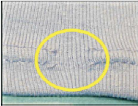
**DESCRIPCIÓN:** Donde el hilo en la costura se ha roto dejando una abertura en la línea de la costura. Causado por: 1) Puntada inapropiada para la aplicación; 2) Tensión inadecuada del hilo para la costura; 3) Insuficientes puntadas por pulgada.
