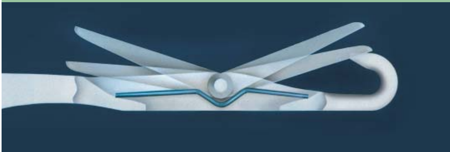
Modelo de corte – aguja de lengüeta con muelle
