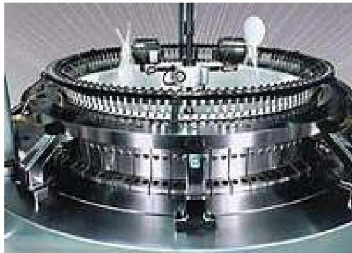
Alimentador de hilos en doble fontura circular
